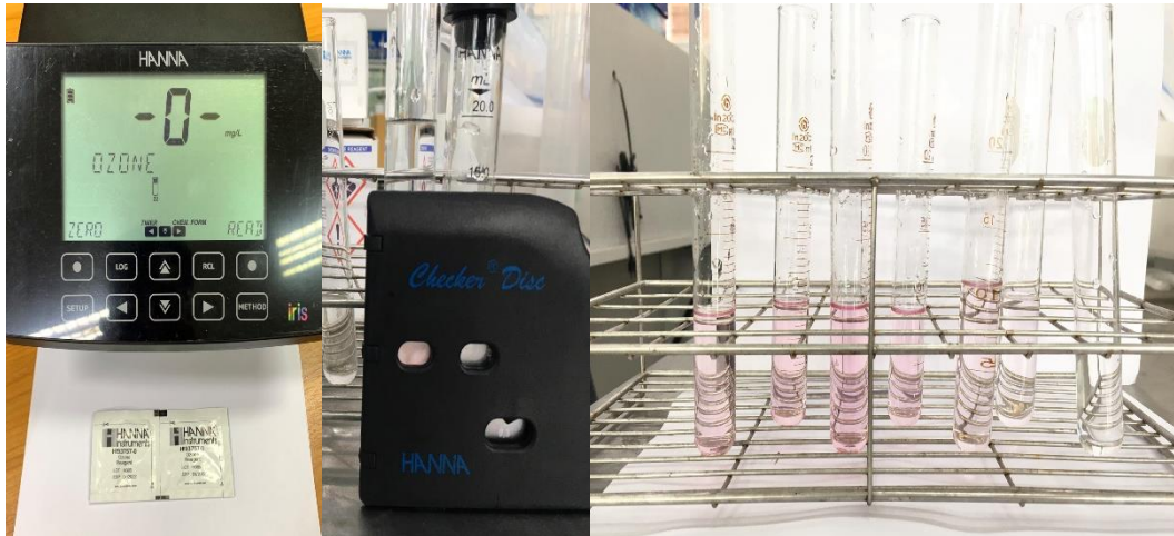
ภาพที่ 44 การวิเคราะห์ความเข้มข้นของโอโซนละลายในน้ำ
