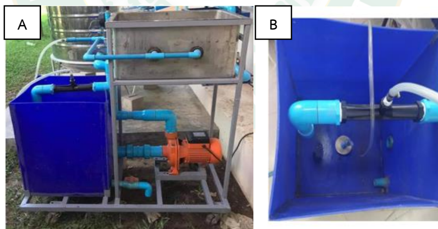
ภาพที่ 43 ระบบสร้างน้ำโอโซน (A) ระบบหัวฉีดเวนจูรี่ (B) ระบบการกระจายฟองด้วยตีฟิวเซอร์
