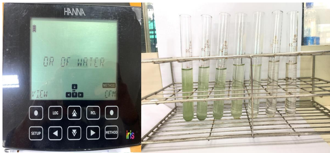
ภาพที่ 46 การวิเคราะห์ค่าสีปรากฏของน้ำหลังการบำบัด
