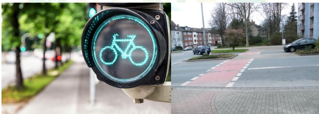
ภาพที่ 40 : ทางจักรยานที่ใช้พื้นที่ร่วมกับการจราจรประเภทอื่น โดยมีป้ายหรือเครื่องหมายชัดเจน
