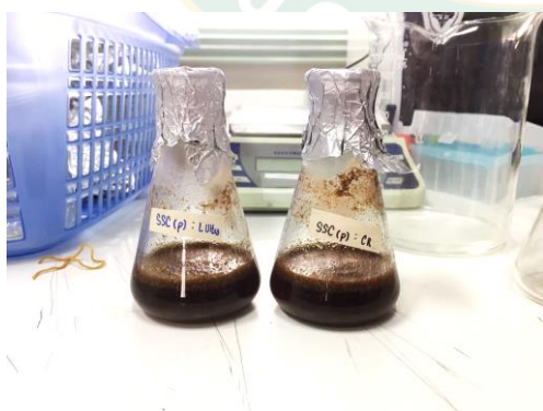
ภาพที่ 13 เยื่อหุ้มเมล็ดกาแฟที่ย่อยด้วยเอนไซม์เซลลูเลส L Ultra conc
