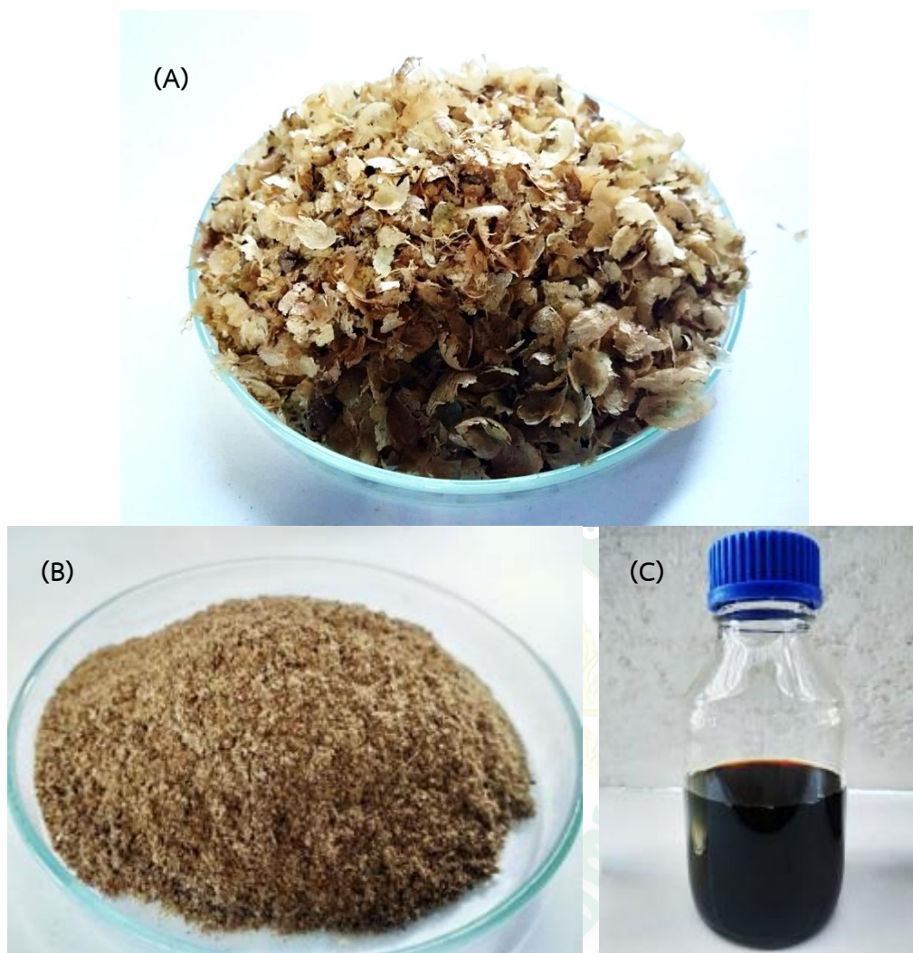
ภาพที่ 11 เยื่อหุ้มเมล็ดกาแฟ (CSS)(A) เยื่อหุ้มเมล็ดกาแฟบด (CSSp)(B) สารสกัดจากเยื่อหุ้มเมล็ดกาแฟ (CSSw)(C)
