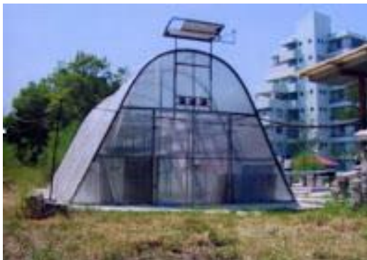
ภาพที่ 15 โดมอบแห้งที่ใช้พลังงานแสงอาทิตย์และมีพัดลมช่วยระบายอากาศ ที่มา: (วรุฒิ บุตรเวา 2552)
