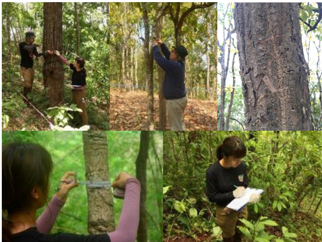
ภาพผนวกที่ 7 การวัดเส้นผ่านศูนย์กลางที่ระดับความสูงเพียงอก 1.30 เมตร (DBH) ติดหมายเลขต้น และบันทึกข้อมูล
