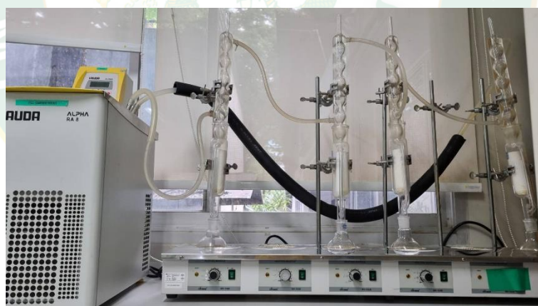
ภาพผนวกที่ 12 เครื่องวัดปริมาณน้ำมันในเมล็ดขนาน้ำมัน Soxhlet system [Lauda (Alpha RA8) + SOXHLET Extraction stirring mantles (EAMS-SERIES)]
