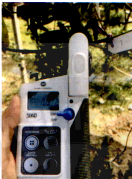
ภาพที่ 37 ทำการวัดปริมาณคลอโรฟิลล์ในใบมะกั้งโดยใช้เครื่อง SPAD
