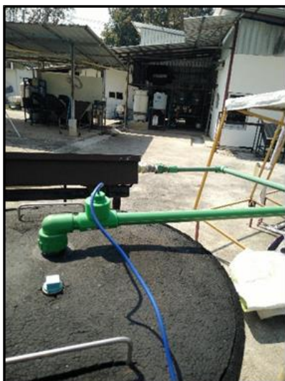
(ค) จุดวัดอุณหภูมิน้ำออกตัวเก็บรังสีอาทิตย์
