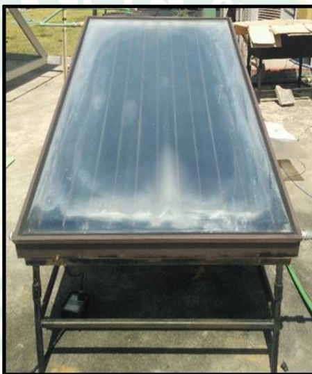
ภาพที่ 20 ตัวเก็บรังสีอาทิตย์แบบแผ่นเรียบที่ใช้ในการศึกษา
