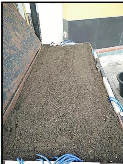
ภาพที่ 35 วัสดุปลูกตัวอย่างที่ถูกบรรจุลงในกระบะทดสอบซึ่งเป็นอุปกรณ์แลกเปลี่ยนความร้อน
