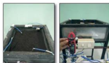
(ก) วัสดุปลูก (ข) ชุดทดสอบ Hot plate รูปที่ 1 การทดสอบหาค่าการนำความร้อนของวัสดุปลูก
