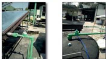
(ข) จุดวัดอุณหภูมิน้ำเข้าแมง (ค) จุดวัดอุณหภูมิน้ำออกแมง รูปที่ 2 การทดสอบหาประสิทธิภาพตัวเก็บรังสีอาทิตย์
