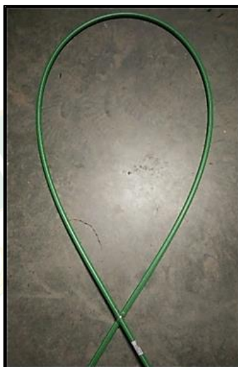
ภาพที่ 27 ท่อน้ำร้อน PPR
