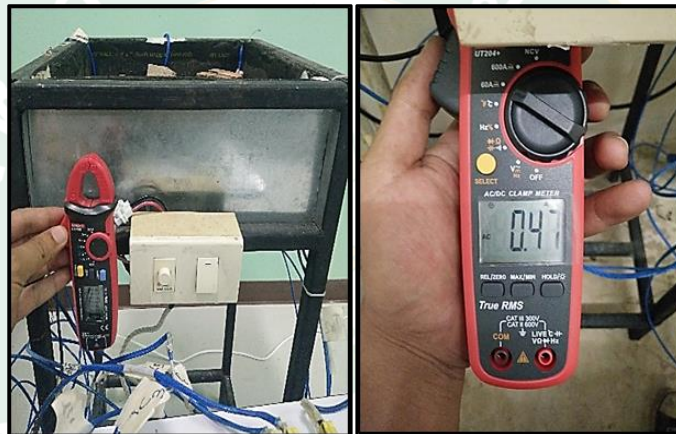
(ข) การปรับกระแสไฟฟ้าในชุดลดความร้อนโดยใช้ Dimmer switch ให้อยู่ที่ 0.4-0.5 A
