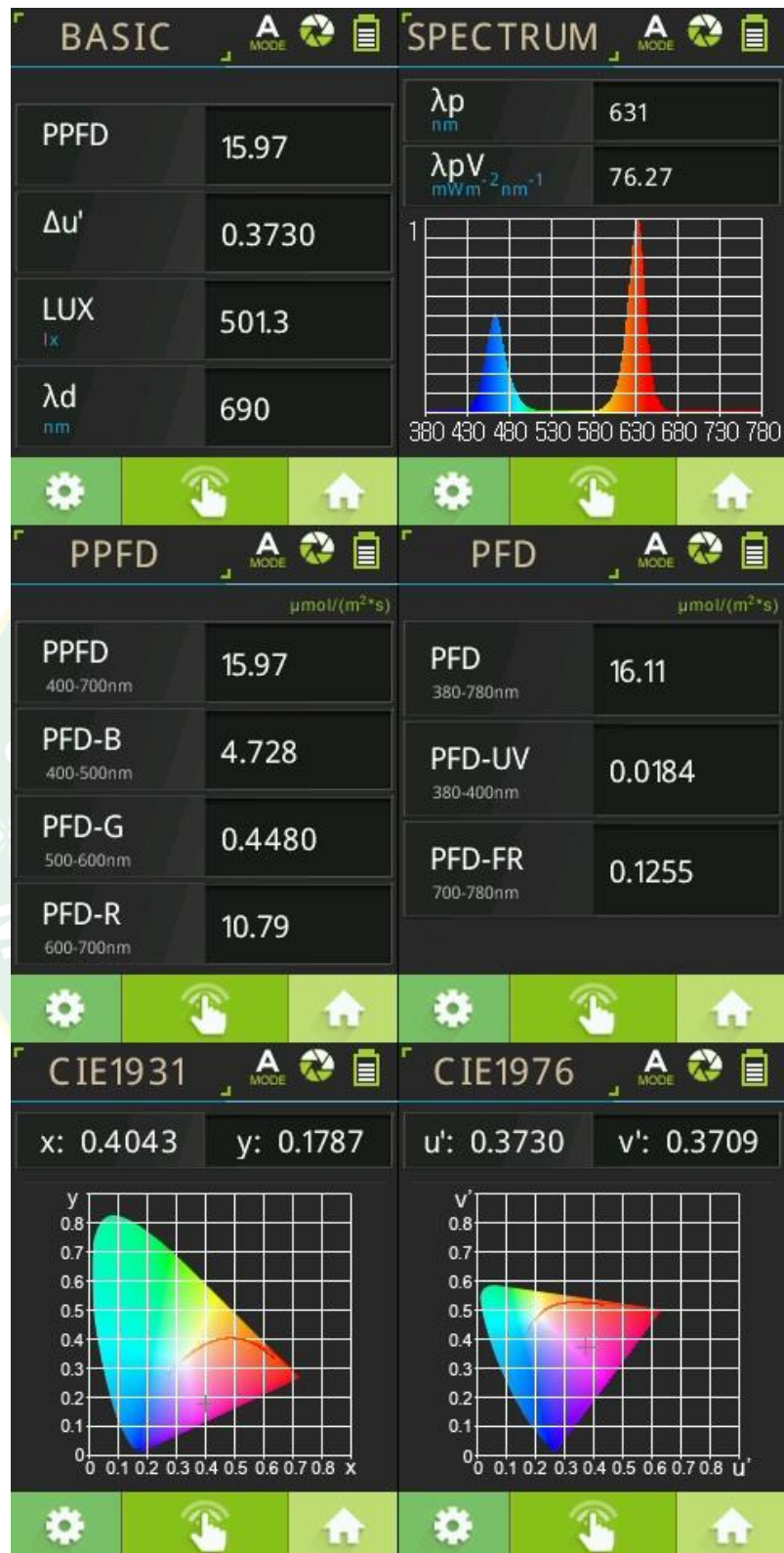
ภาพที่ 1 สเปกตรัมแสงของชุดให้แสงหลอด LED สีแดงร่วมกับสีน้ำเงินอัตราส่วน 3:1
