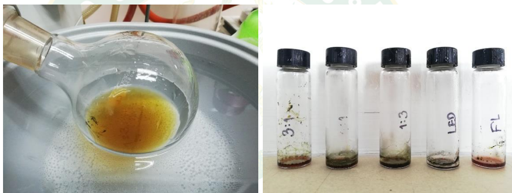
ภาพที่ 14 การระเหยสารสกัดด้วยเครื่องระเหยสุญญากาศ
