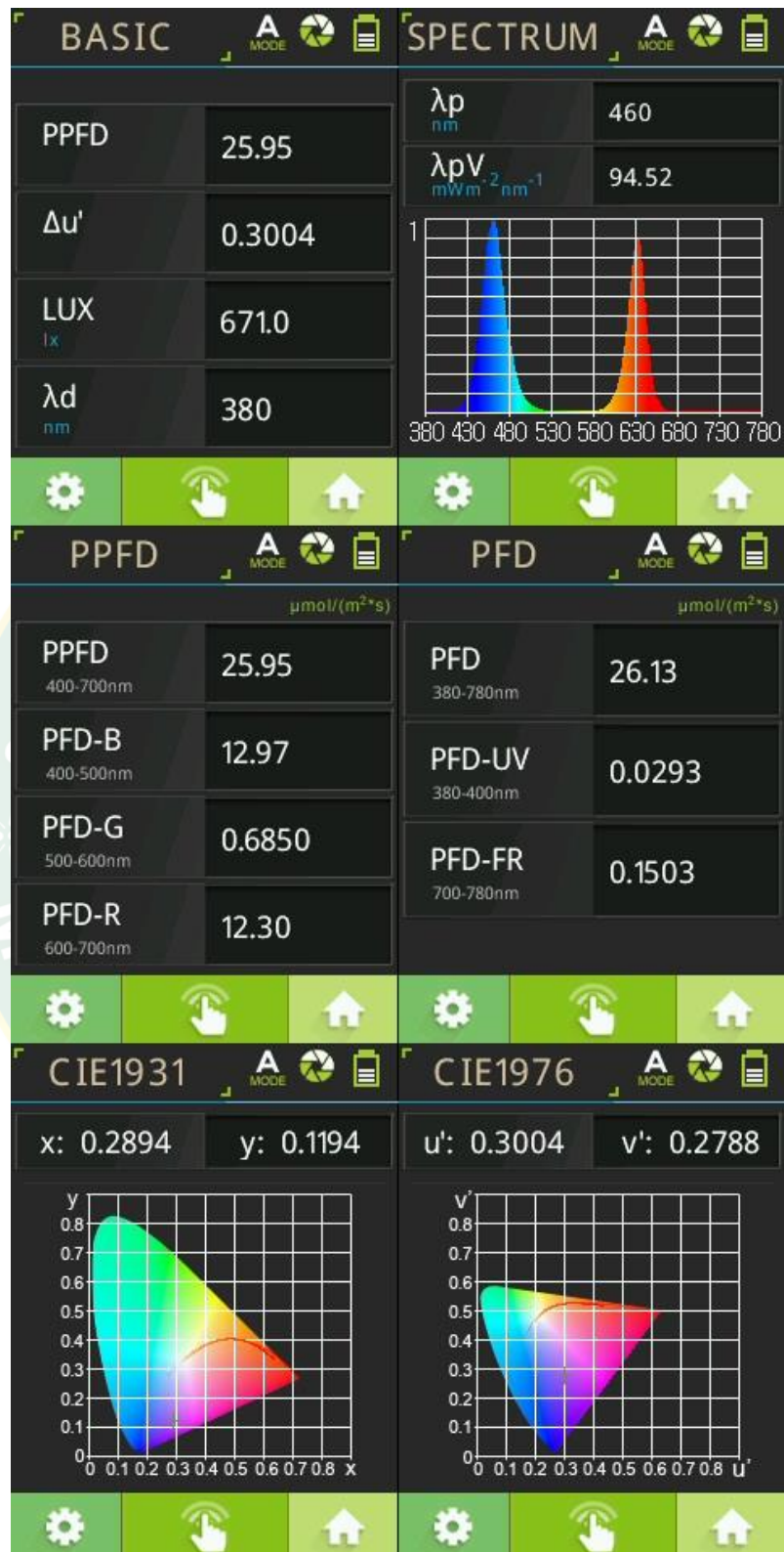
ภาพที่ 2 สเปกตรัมแสงของชุดให้แสงหลอด LED สีแดงร่วมกับสีน้ำเงินอัตราส่วน 1:1
