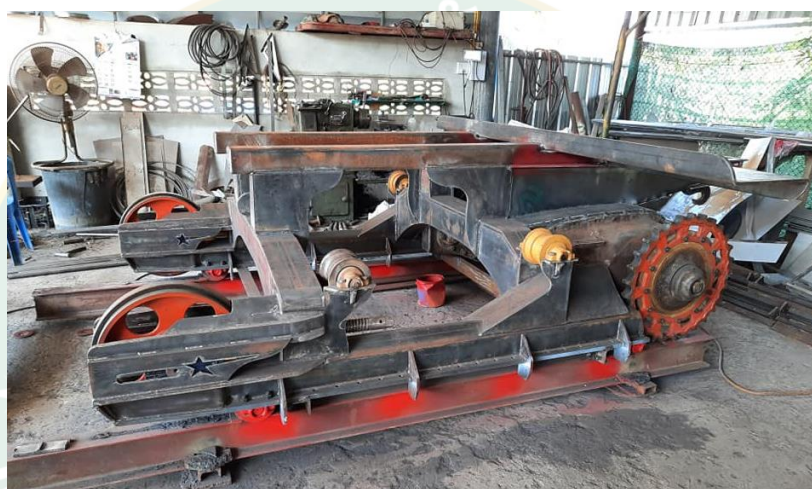
ภาพที่ 2 ชุดช่วงล่างเครื่องเกี่ยวขนาดข้าว
