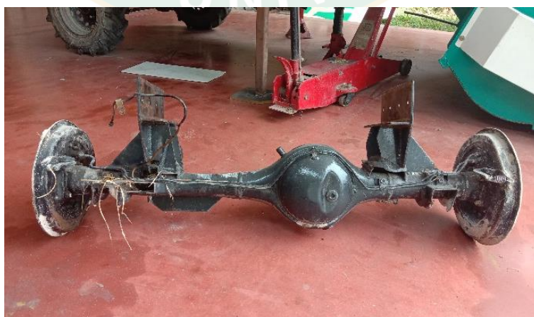
ภาพที่ 20 เพลาขับเคลื่อนก่อนการพัฒนาได้รับความเสียหาย
