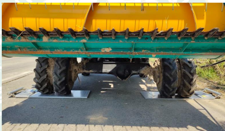
ภาพที่ 19 ชั่งน้ำหนักเครื่องเกี่ยวขนาดข้าวทั้ง 4 ล้อ
