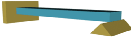
คานปลายยื่นแต่มีจุดรับที่ปลายยื่น (Restrain Beam)
