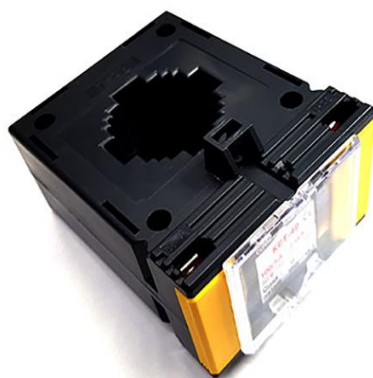
ภาพผนวกที่ 15 เครื่องวัดและบันทึกค่าพลังงานยี่ห้อ Kepler Series current transformer 3 phase รุ่น KCT-60-400/5A
