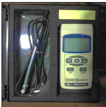
ภาพผนวกที่ 17 เครื่องวัดอัตราเร็วลม (Anemometer) ยี่ห้อ Lutron รุ่น AM-4215SD แบบ Hot wire Anemometer
