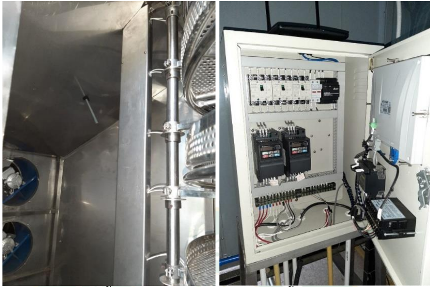
ภาพที่ 21 ก.) การติดตั้งอุปกรณ์ตรวจวัดอุณหภูมิ ความชื้นของอากาศ และความเร็วลม, ข.) อุปกรณ์ควบคุมรอบมอเตอร์หมุนถาดอบแห้งและพัดลมหมุนเวียนอากาศ
