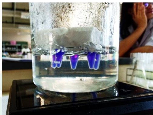
ภาพผนวกที่ 18 การต้มให้ความร้อนที่อุณหภูมิน้ำเดือดเพื่อให้โปรตีนเสียสภาพ
