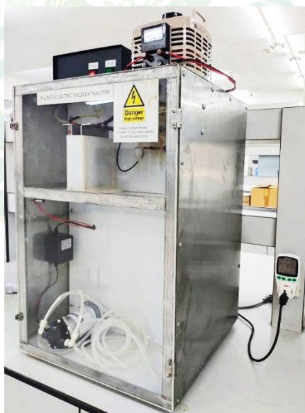
ภาพผนวกที่ 12 การวัดพลังงานไฟฟ้าเพื่อนำไปวิเคราะห์ความสัมพันธ์พลังงานจำเพาะ
