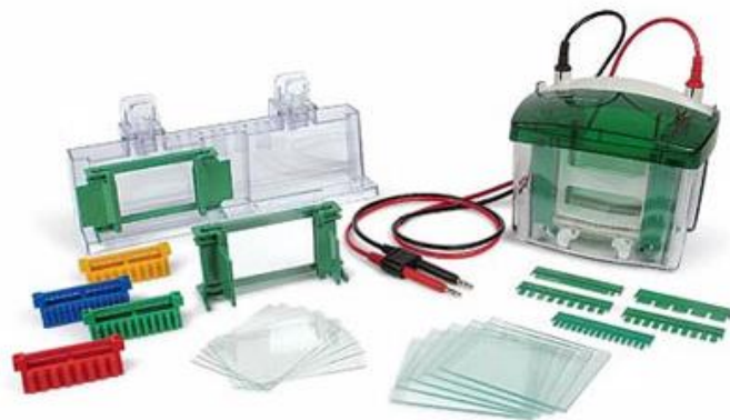
ภาพผนวกที่ 14 ชุดอุปกรณ์สำหรับการทำ SDS-PAGE
