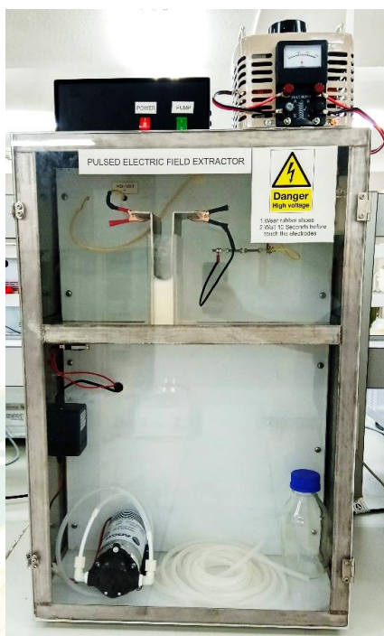
ภาพผนวกที่ 1 การสกัดโปรตีนด้วยสนามไฟฟ้าแรงสูงแบบจั้งหะ
