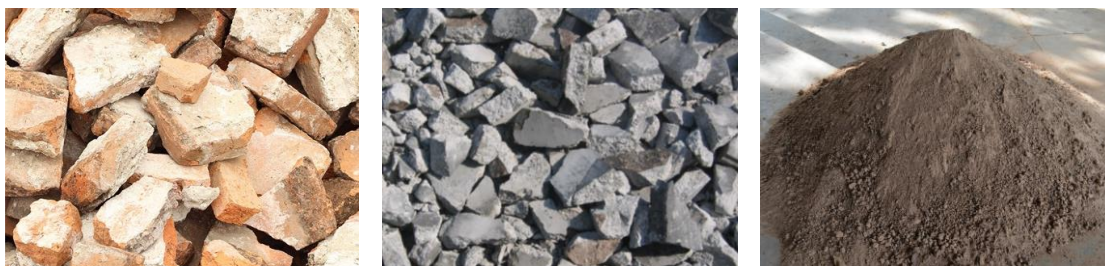
ภาพที่ 13 ลักษณะของวัสดุกรองที่ใช้ในการศึกษา
