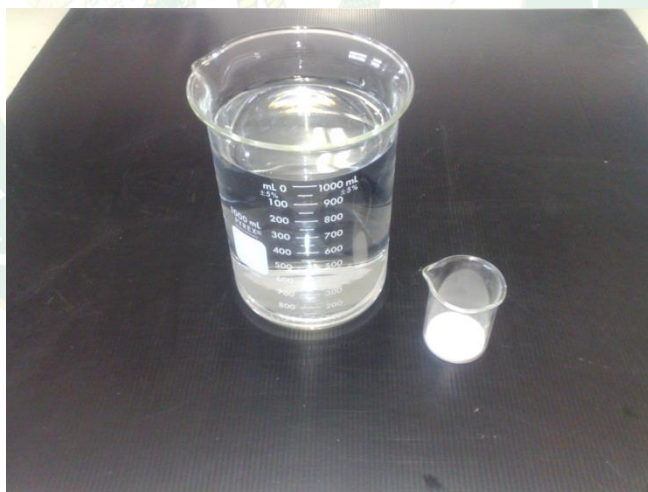
ภาพผนวกที่ 13 เตรียมน้ำบริสุทธิ์ปริมาตร 1000 mL เพื่อละลาย โซเดียมคลอไรด์ 5.85 g
