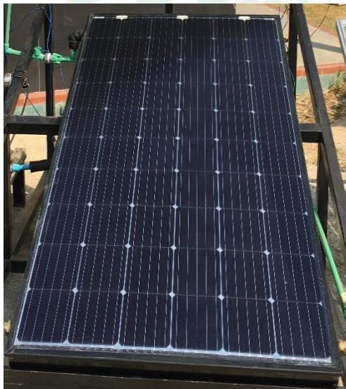
ภาพที่ 21 แผงผลิตไฟฟ้าและน้ำร้อนพลังงานแสงอาทิตย์แบบมีกระจกครอบ
