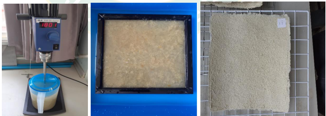
ภาพที่ ค-6 การปั่นเยื่อและการขึ้นแผ่นกระดาษ
