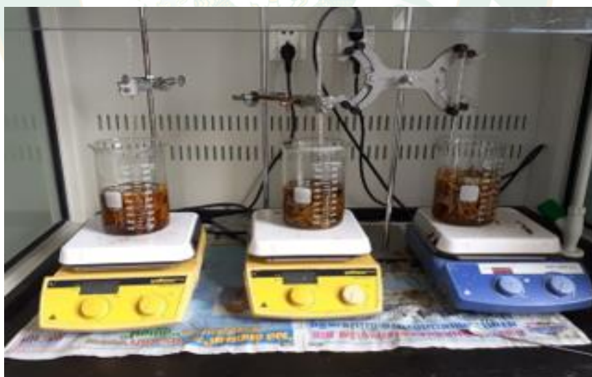
ภาพที่ 15 การต้มเยื่อกระดาษจากชนิดฟางข้าวด้วยโซเดียมไฮดรอกไซด์ที่เข้มข้นต่าง ๆ ในห้องปฏิบัติการ
