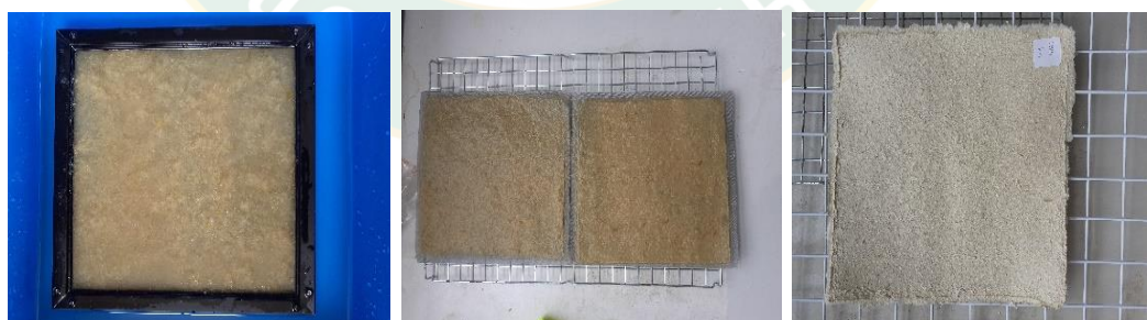
ภาพที่ 19 การขึ้นแผ่นกระดาษ และการตากแผ่นกระดาษฟางข้าว
