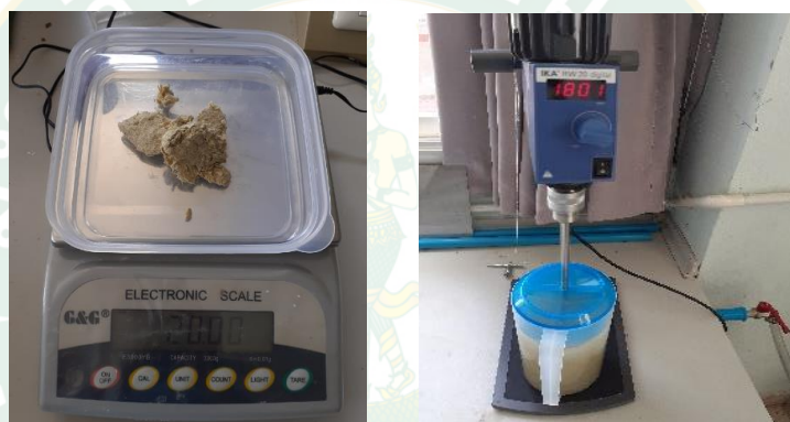
ภาพที่ 18 การชั่งน้ำหนักเยื่อ และการปั่นเยื่อกระดาษ
