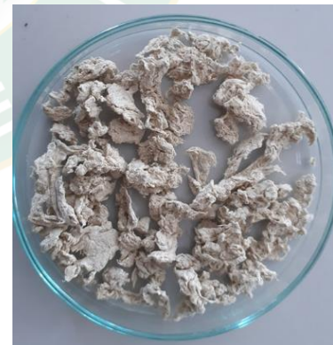
ภาพที่ ค-4 การต้มเยื่อกระดาษฟางข้าวโดยใช้โซเดียมไฮดรอกไซด์ ในห้องปฏิบัติการ
