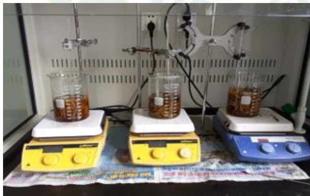
ภาพที่ ค-4 การต้มเยื่อกระดาษฟางข้าวโดยใช้โซเดียมไฮดรอกไซด์ ในห้องปฏิบัติการ
