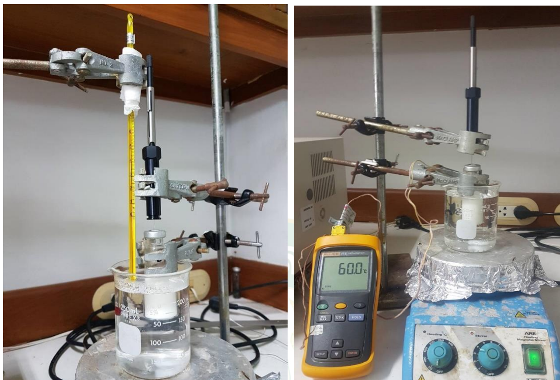
ภาพที่ 8 การสกัดด้วยการดูดซับกลืนด้วย SPME fibers
