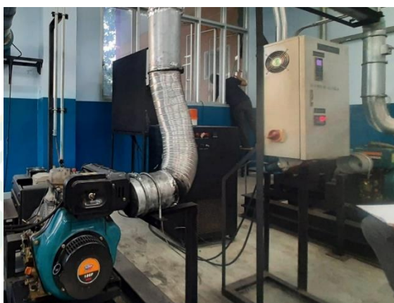
ภาพที่ 30 ชุดทดสอบสมรรถนะเครื่องยนต์
