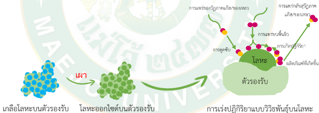
ภาพที่ 9 การเตรียมตัวเร่งปฏิกิริยาบนตัวรองรับ
