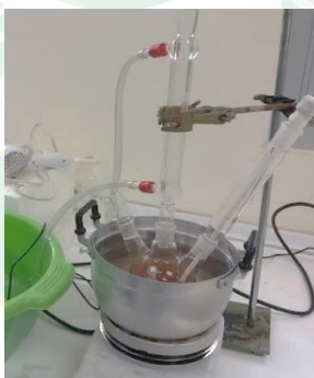
ภาพที่ 26 การผลิตไบโอดีเซลในระดับห้องปฏิบัติการ
