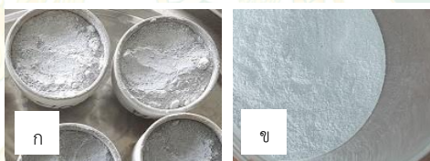
ภาพที่ 25 เถ้าหอยขมบนตัวรองรับเถ้าแกลบข้าวที่ผ่านการแคลไซน์แล้ว ก) เถ้า RSSA/RHA ที่ผ่านการแคลไซน์แล้ว และ ข) ผงเถ้า RSSA/RHA ละเอียด
