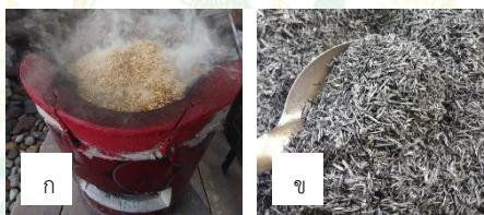
ภาพที่ 21 การนำแกลบข้าวมาเผาด้วยเตาชีวมวลความร้อนสูง
