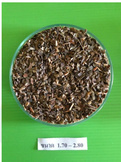
ภาพที่ 5 เปลือกหอยเชอร์รี่บดขนาด 1.70-2.80 มิลลิเมตร
