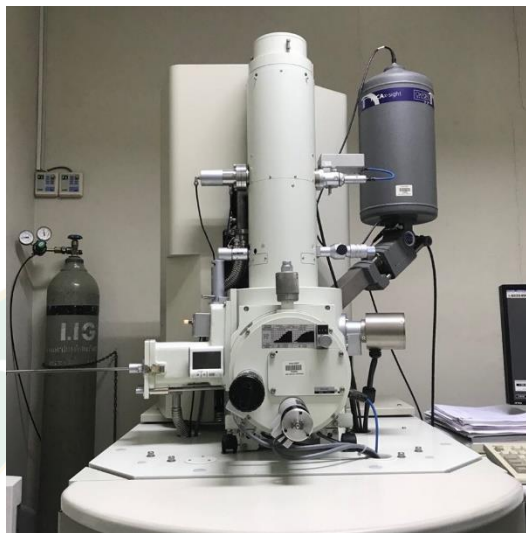
รูปที่ 7 กล้องจุลทรรศน์อิเล็กตรอนชนิดส่องกราด
