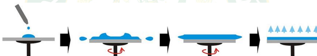
รูปที่ 18 เทคนิคการเหวี่ยงเคลือบ (Laurell Technologies Corporation 2019)
