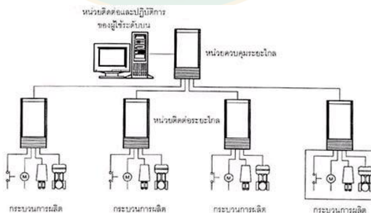
ภาพที่ 17 การติดตั้งสกาด้าสำหรับตรวจสอบเก็บรวบรวมข้อมูลและบริหารระบบควบคุม
