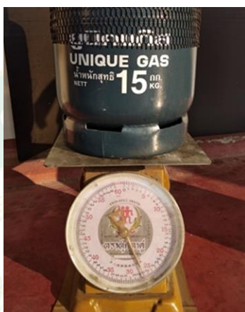
ภาพที่ 33 เครื่องชั่งน้ำหนัก 60 กิโลกรัม
