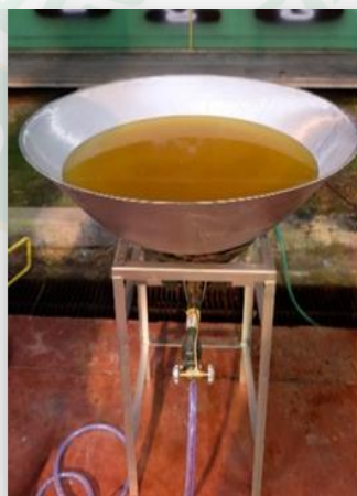
ภาพที่ 30 เตรียมน้ำมันสำหรับการทดสอบตัวอย่างของกระทะทั่วไป
