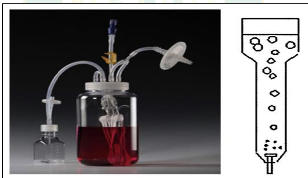
ภาพที่ 12 ระบบโฟโตไบโอรีแอกเตอร์แบบ Bubble column
