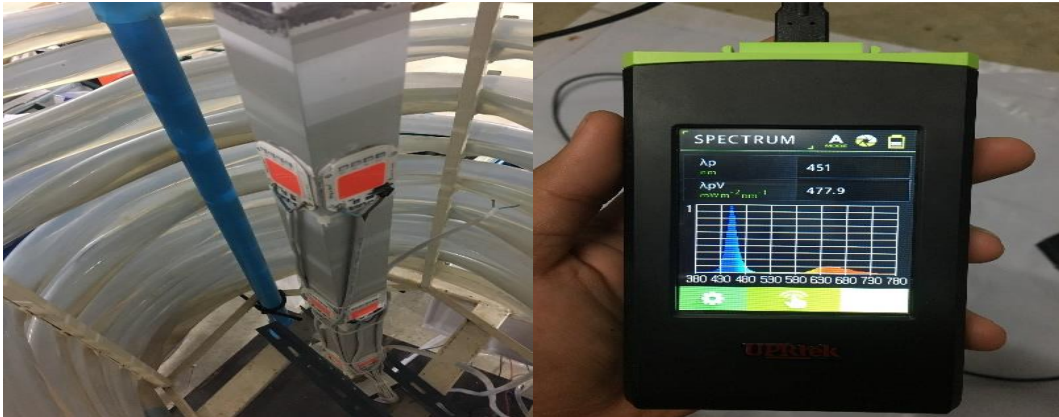
ภาพที่ 28 LED COB บนท่ออะลูมิเนียมและการวัดช่วงความยาวคลื่นแสง
