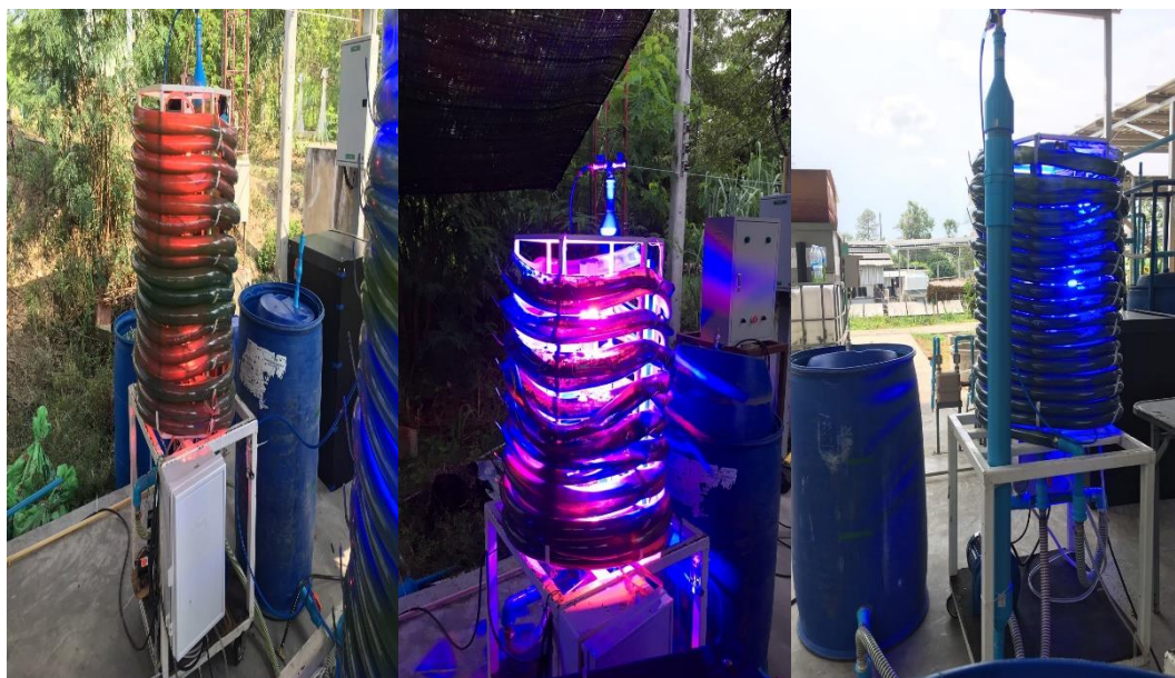
ภาพที่ 45 ระบบโฟโตโวลเทอิกแอกเตอร์แบบท่อขดขณะเปิดแสง LED
