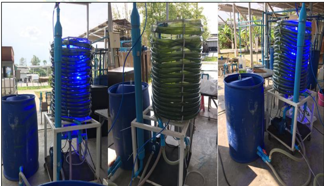
ภาพที่ 44 ระบบโฟโตไบโอรีแอกเตอร์แบบท่อขด
