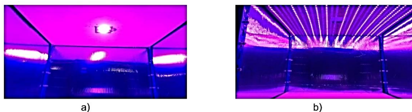
Figure 1 การติดตั้ง LED สีน้ำเงินผสมแดง a) LED COB และ b) LED SMD 5050
