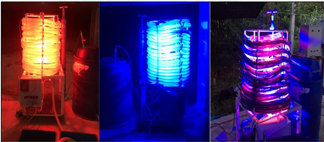
ภาพที่ 29 แสงจากหลอด LED COB ทั้ง 3 สี ของระบบโฟโตไบโอรีแอกเตอร์แบบท่อขด
