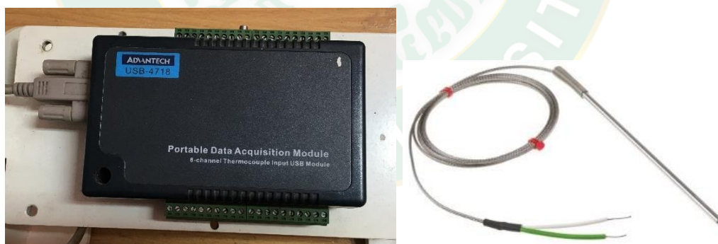
ภาพที่ 25 เครื่องวัดอุณหภูมิและสายเทอร์โมคัปเปิ้ล ชนิด K
