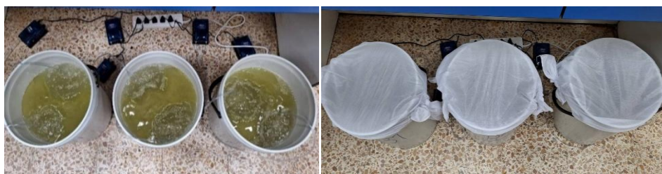
ภาพที่ 17 ชุดถังปฏิกรณ์พลาสติกทึบ ขนาด 20 ลิตร ที่มีปริมาตรน้ำเสีย 15 ลิตร เต็มอากาศ เพื่อศึกษาประสิทธิภาพการกำจัดไขมันในน้ำเสียของโรงงานผลิตอาหารแปรรูปเนื้อไก่แช่แข็ง
