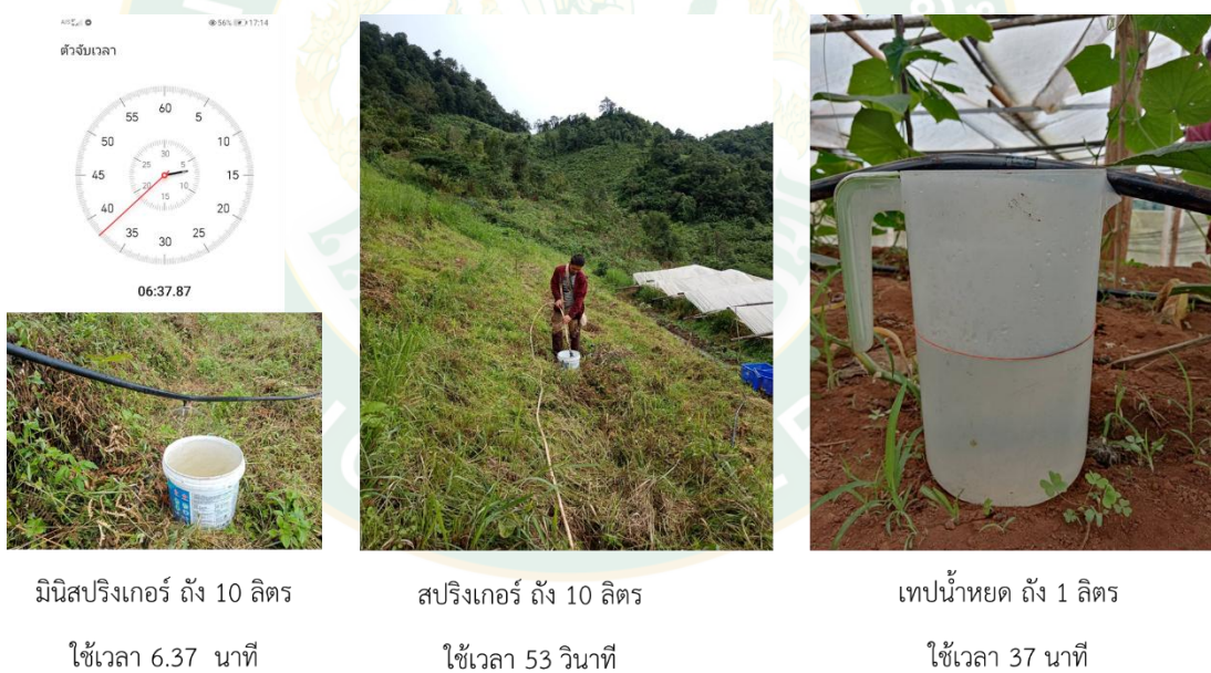
ภาพที่ 28 การจับเวลาวัดดวงอัตราการไหลของน้ำแต่ละรูปแบบ
