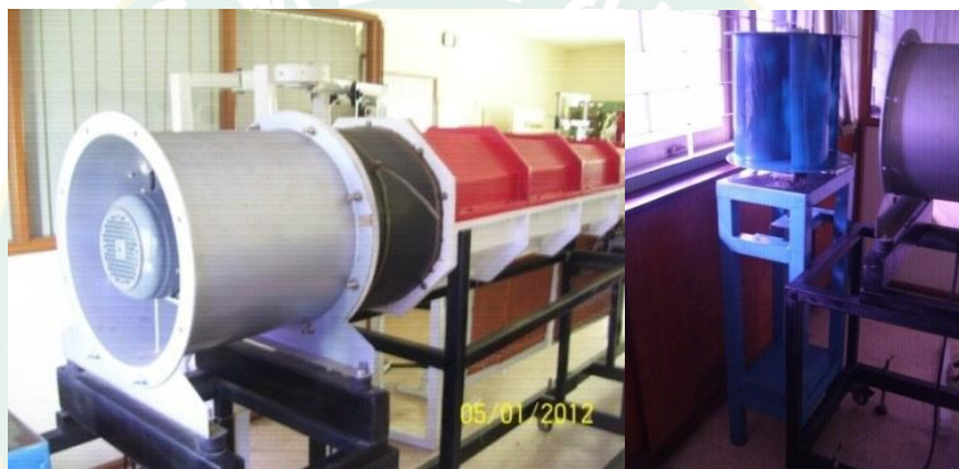
ภาพที่ 22 การติดตั้งกังหันลมเพื่อทดสอบกับอุโมงค์ลม
