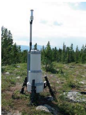
ภาพที่ 16 เครื่องวัดอัตราเร็วลมแบบเลเซอร์
