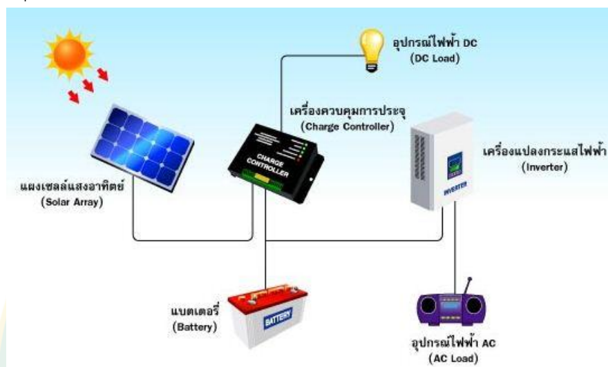
ภาพที่ 5 ระบบการผลิตกระแสไฟฟ้าจากเซลล์แสงอาทิตย์
