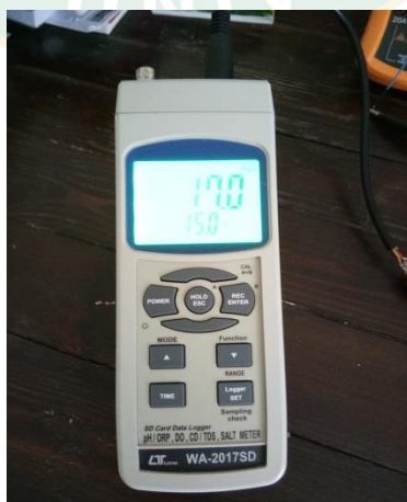
ภาพที่ 12 เครื่องวัดปริมาณออกซิเจนและวัดเป็นความกรด-ด่าง Lutron รุ่น WA-2017SD ที่มา: เลกะ (ม.ป.ป.)
