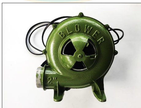
ภาพที่ 24 พัดลมป้อนอากาศ
