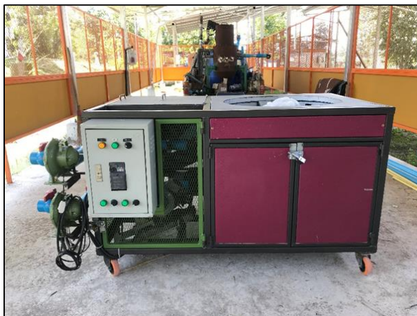
ภาพที่ 17 เตาชีวมวลชนิดบ้อนเชื้อเพลิงแบบต่อเนื่อง
