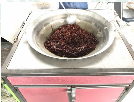
ภาพที่ 36 การคั่วพริกโดยใช้เตาชีวมวลชนิดป้อนเชื้อเพลิงแบบต่อเนื่อง
