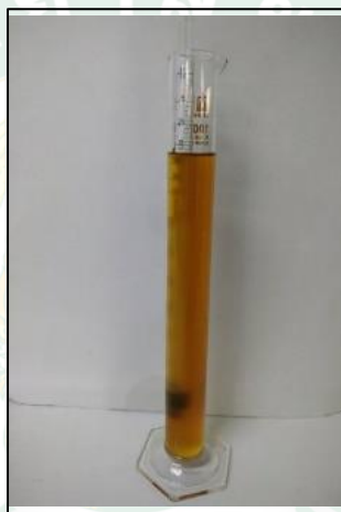
ภาพที่ 7 การใช้ไฮโดรมิเตอร์วัดความหนาแน่นของน้ำมัน
