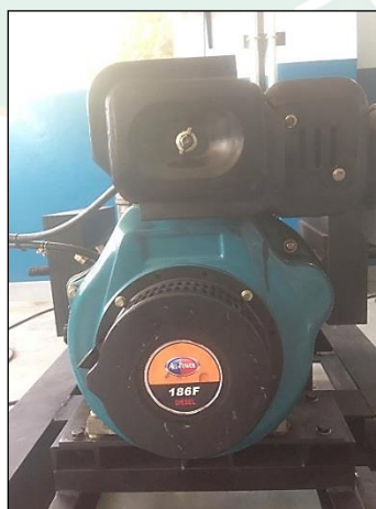
ภาพที่ 4 เครื่องยนต์ดีเซลขนาดเล็ก All Power รุ่น 186 F
