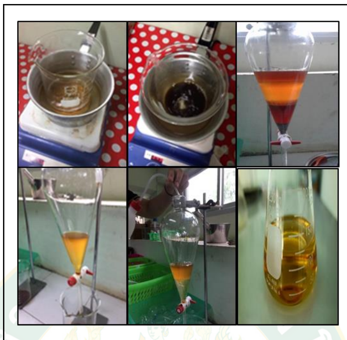
ภาพที่ 5 วิธีการผลิตไบโอดีเซลจากน้ำมันพืชที่ใช้แล้ว
