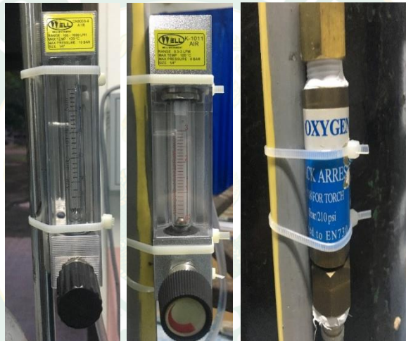
ภาพที่ 29 โรตاميเตอร์อากาศขนาด 100-1,000 LPH และ 0.3-3 LPM และอุปกรณ์ป้องกัน ก๊าซออกซิเจนย้อนกลับเข้าถังก๊าซ
