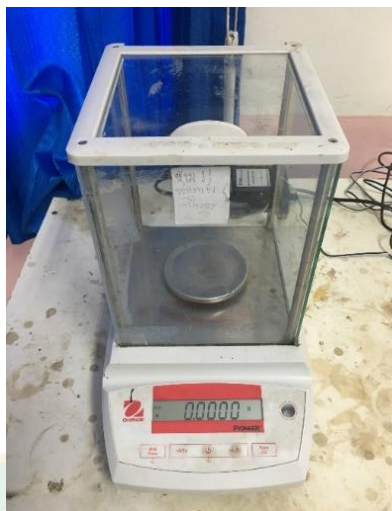
ภาพที่ 37 เครื่องชั่งน้ำหนักแบบดิจิทัล 4 ตำแหน่ง
