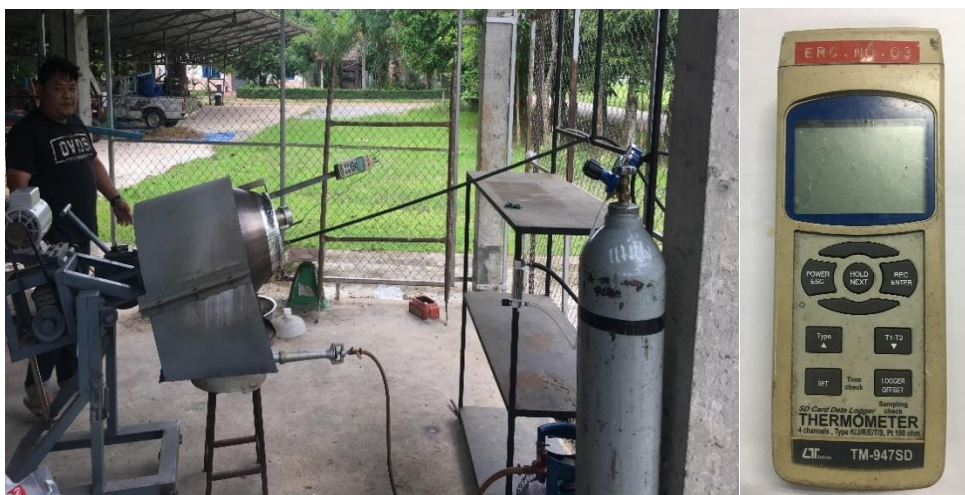
ภาพที่ 31 เครื่องผลิตถ่านชีวภาพแบบ Pilot Scale และเครื่องวัดอุณหภูมิ
