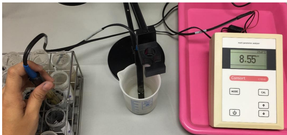
ภาพที่ 41 เครื่องวัดค่า pH และสภาพการนำไฟฟ้า
