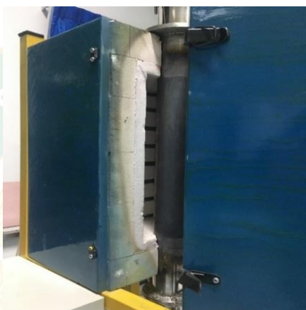
ภาพที่ 22 ห้องเชื้อเพลิง
