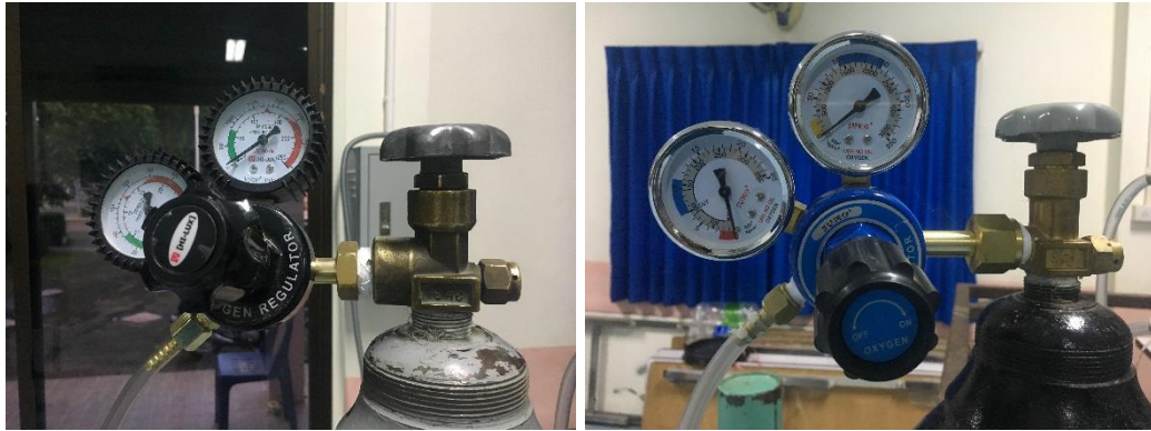
ภาพที่ 28 เกจก๊าซไนโตรเจนและก๊าซออกซิเจน
