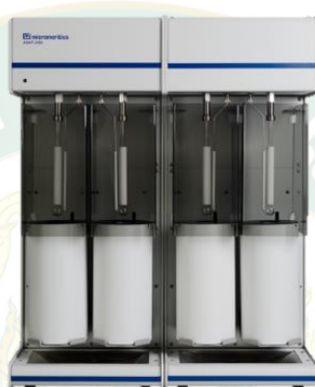
ภาพที่ 49 เครื่องวัดการกระจายขนาดและรูพรุน (BET)
