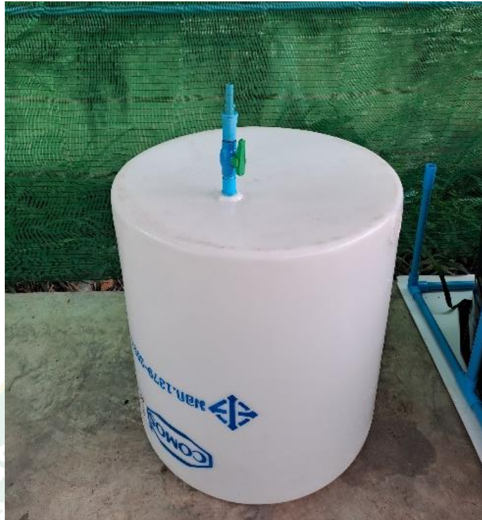
ภาพผนวกที่ 6 การเจาะรูของถังปฏิกรณ์ (ฝาถังปฏิกรณ์)
