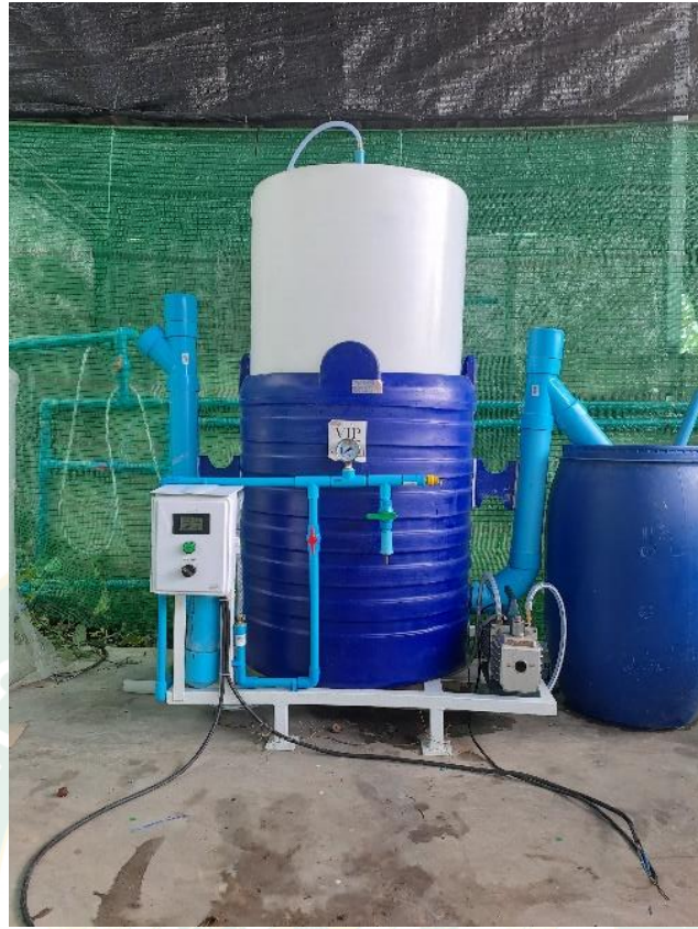
ภาพผนวกที่ 13 การประกอบอุปกรณ์ของถังเก็บก๊าซชีวภาพ
