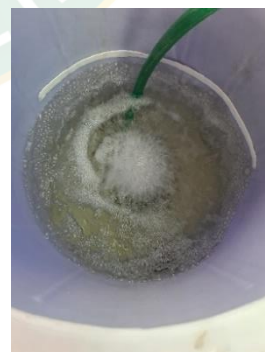
(ค) ทดสอบหัวจ่ายก๊าซ
