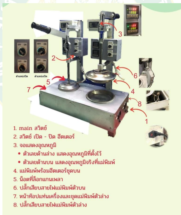
ภาพที่ 17 เครื่องผลิตภาชนะใบไม้เพื่อการผลิตระดับชุมชน รุ่นที่ 3 มีโยกสองหัวกด
