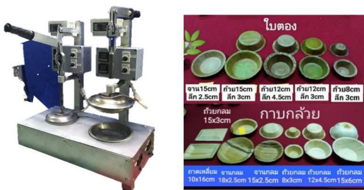
ภาพที่ 3 เครื่องอัดกระทงใบตองแบบสองหัวกด รุ่น 3
