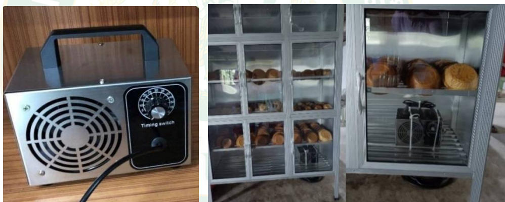
ภาพที่ 19 แสดงเครื่องอบโอโซนและตู้อบโอโซนฆ่าเชื้อโรค
