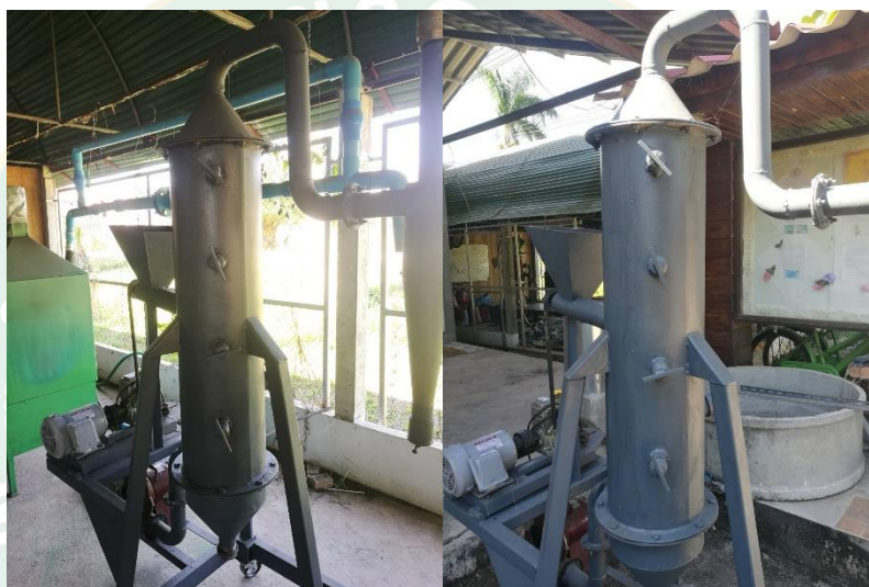
ภาพที่ 37 ห้องเผาไหม้ระบบผลิตแก๊สชีววมวลแบบฟลูอิดซ์เบด
