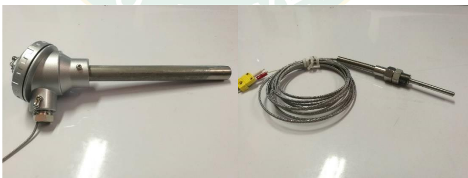
(a) เทอร์โมคัปเปิลใช้วัดอุณหภูมิที่จุด T1-T4 (b) เทอร์โมคัปเปิลใช้วัดอุณหภูมิที่จุด T5,T8
