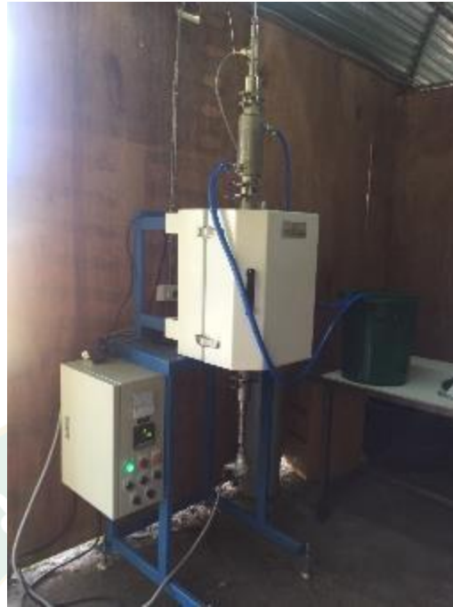
ภาพที่ 21 เครื่องผลิตเชื้อเพลิงทอรรีไฟต์
