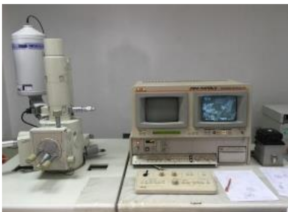
ภาพที่ 29 กล้องจุลทรรศน์อิเล็กตรอนแบบส่องกราด
