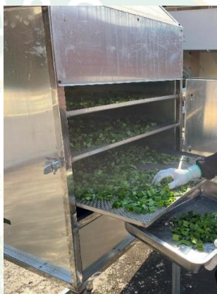
ภาพที่ 8 การอบแห้งด้วยเครื่องอบแห้งพลังงานแสงอาทิตย์ด้วยท่อลมร้อนร่วมกับตัวรับรังสีดวงอาทิตย์แบบรางพาราโบลา
