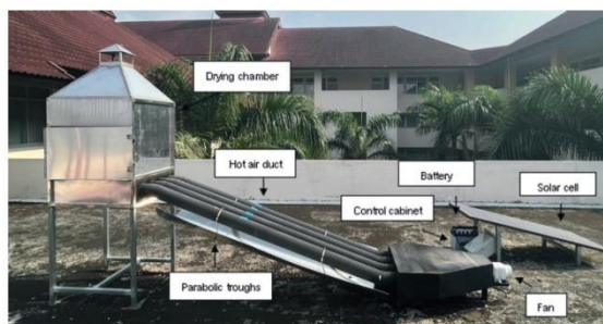
ภาพที่ 2 แบบโครงสร้างและลักษณะของระบบอบแห้ง
