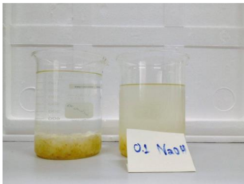
ภาพผนวก ค 2 เติมสาร NaOH 0.1 นอร์มอล กวนเป็นเวลา 24 ชั่วโมง ที่อุณหภูมิ 4 °C
