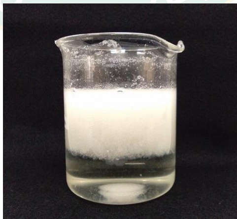
ภาพผนวก ค 7 นำส่วนของเหลวที่ได้ มาเติม NaCl เพื่อตกตะกอนโปรตีน
