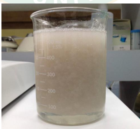
ภาพผนวก ค 18 นำส่วนของเหลวที่ได้ มาเติม NaCl เพื่อตกตะกอนโปรตีน
