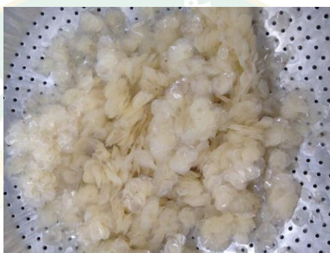
ภาพผนวก ค 3 เกล็ดปลานิลหลังจากแช่ NaOH เพื่อกำจัดโปรตีนที่ไม่ใช่คอลลาเจน
