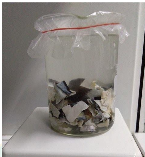
ภาพผนวก ค 13 เติมสาร NaOH 0.1 นอร์มอล กวนเป็นเวลา 24 ชั่วโมง ที่อุณหภูมิ 4 °C
