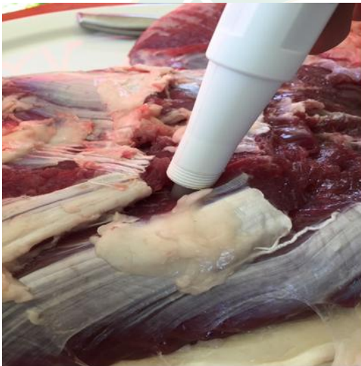
ภาพที่ 22 การวัดระดับประเมินค่าความเป็น กรด-ด่าง เนื้อแดงด้วยเครื่อง pH Meter
