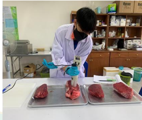
ภาพที่ 21 การประเมินสีของเนื้อแดงด้วยเครื่อง Minolta Chroma Meter
