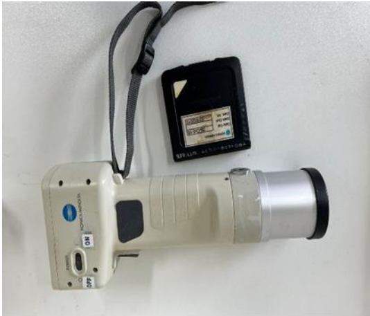
ภาพที่ 21 การประเมินสีของเนื้อแดงด้วยเครื่อง Minolta Chroma Meter
