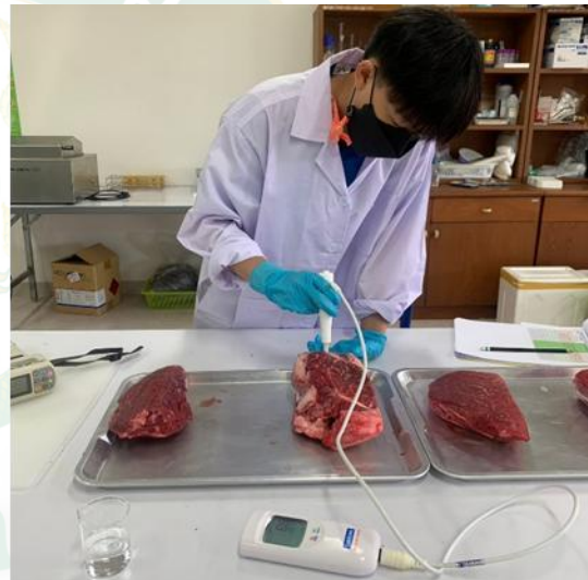
ภาพที่ 22 การวัดระดับประเมินค่าความเป็น กรด-ด่าง เนื้อแดงด้วยเครื่อง pH Meter
