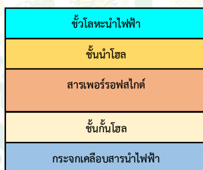
ภาพที่ 5 โครงสร้างพื้นฐานของเซลล์แสงอาทิตย์ชนิดเพอร์รอฟสไกต์
