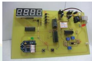
รูปที่ 26 บอร์ดตรวจวัดอุณหภูมิแบบไร้สาย
