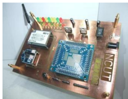
รูปที่ 25 บอร์ดเทอร์มินัลควบคุมส่วนกลางไร้สาย
