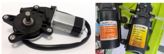
รูปที่ 53 โหลดทดสอบไฟฟ้ากระแสตรง (PZEM017)
