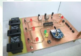
รูปที่ 26 บอร์ดตรวจวัดอุณหภูมิแบบไร้สาย
