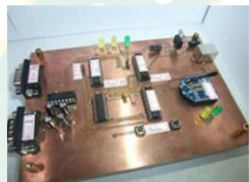
รูปที่ 27 บอร์ดวงจรการประมวลผลข้อมูล เครื่องวัดออกซิเจนที่ละลายในน้ำและ PH แบบ ไร้สาย
