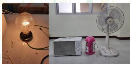
รูปที่ 52 โหลดทดสอบไฟฟ้ากระแสสลับ (PZEM016)
