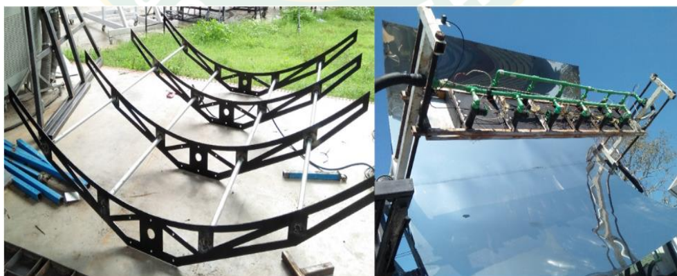
ภาพที่ 39 รางรวมแสงพาราโบลาที่สร้างขึ้นจริง
