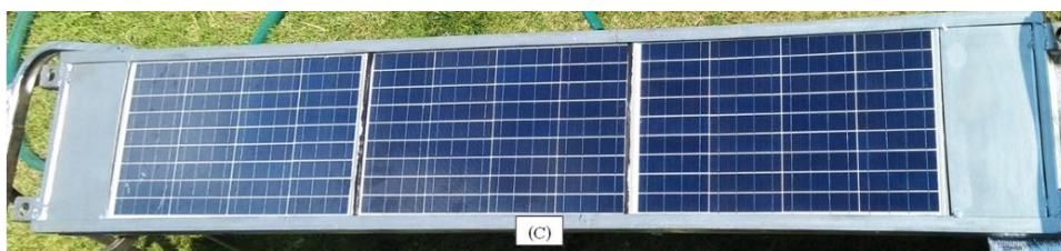
ภาพที่ 40 แผงเซลล์แสงอาทิตย์ที่ประกอบเป็นเป่ารับรังสีอาทิตย์
