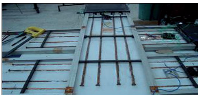
ภาพที่ 29 ชุดท่อความร้อนที่ติดตั้งไว้ด้านหลังแผงเซลล์แสงอาทิตย์
