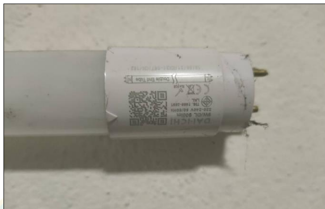
ภาพที่ 57 กำลังไฟฟ้าของหลอดไฟจาก Name Plate
