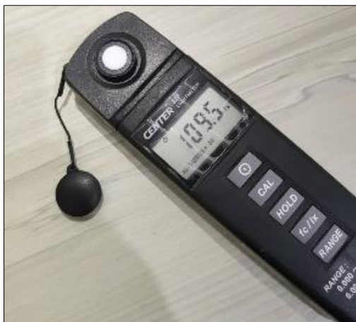
ภาพที่ 58 วัดค่าปริมาณแสงที่ตกกระทบลงบนวัตถุต่อพื้นที่ (Lux) เฉพาะจุดที่ทำงาน
