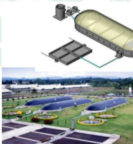
ภาพที่ 39 ระบบผลิตแก๊สชีวภาพแบบพลาสติกคลุมราง
