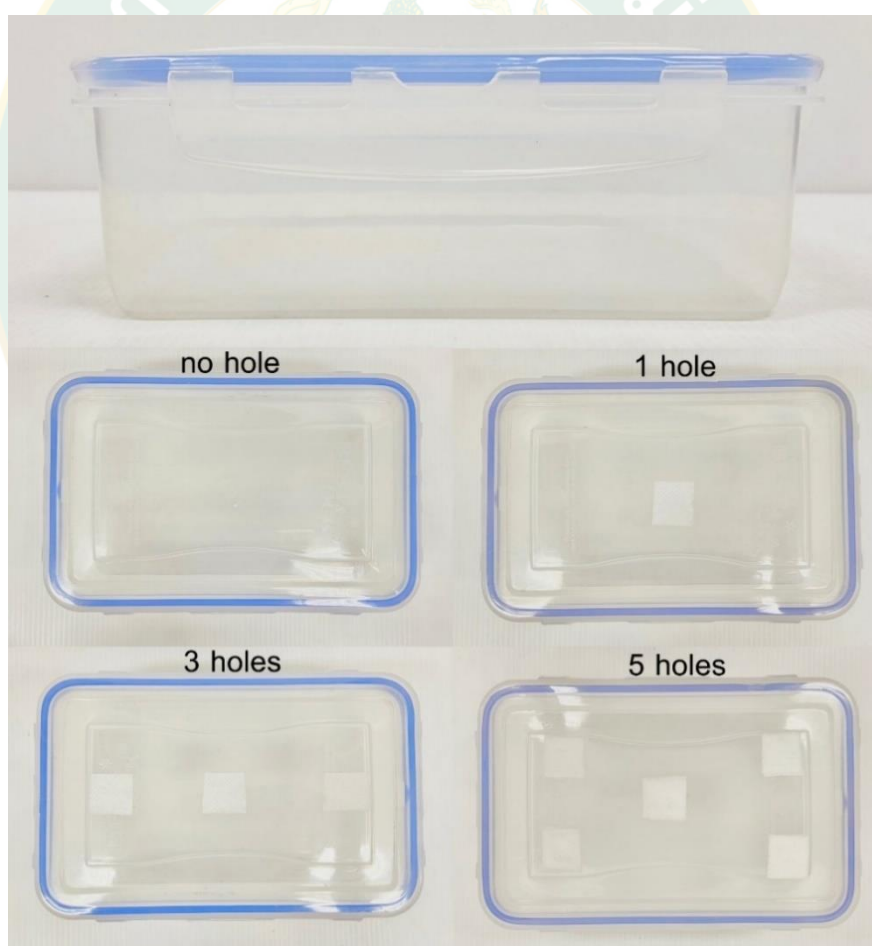
ภาพที่ 7 กล่องพลาสติกขนาด 11.0×18.0×6.5 เซนติเมตร ที่มีรูระบายอากาศจำนวน 0-5 รู สำหรับเพาะเลี้ยงพืชด้วยระบบไมโครโพนิกส์
