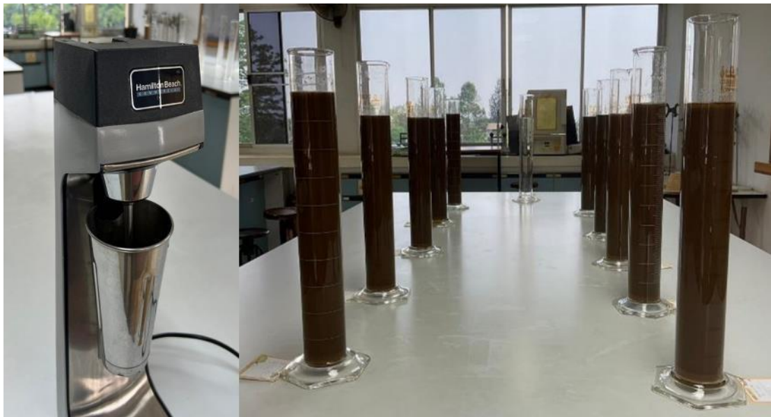
ภาพภาคผนวก 6 การวิเคราะห์เนื้อดินก่อนและหลังการทดลอง
