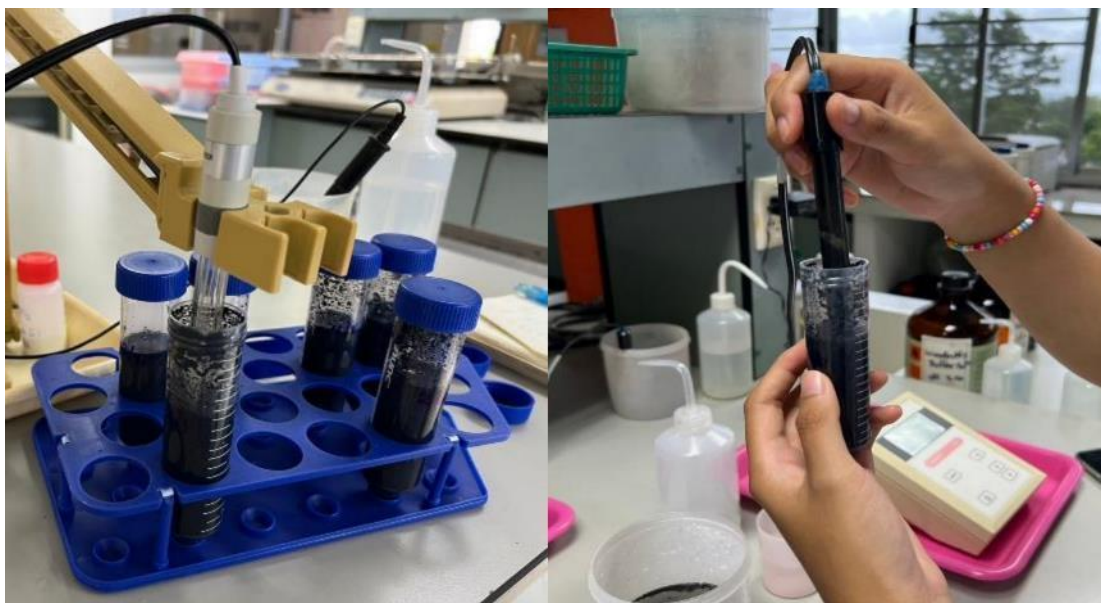
ภาพภาคผนวก 8 การวัดค่าความเป็นกรด-ด่างของดินและถ่านชีวภาพ
