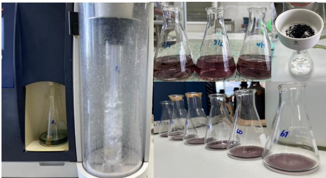
ภาพภาคผนวก 10 การวิเคราะห์ค่าความจุแลกเปลี่ยนแคตไอออนในดินและถ่านชีวภาพ
