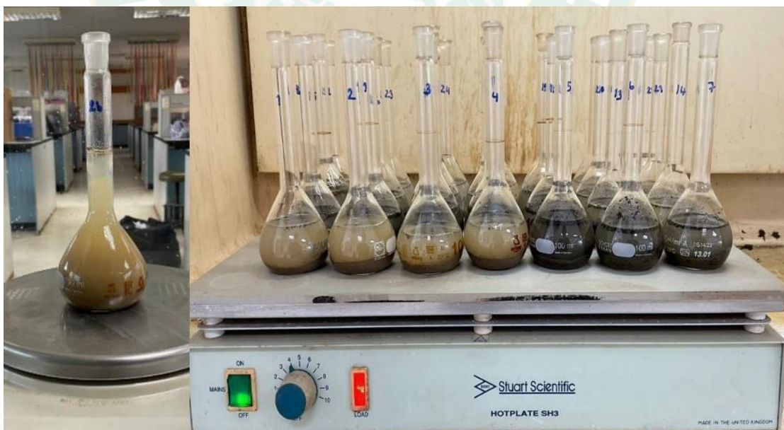
ภาพภาคผนวก 7 การวิเคราะห์ความหนาแน่นของอนุภาคดิน
