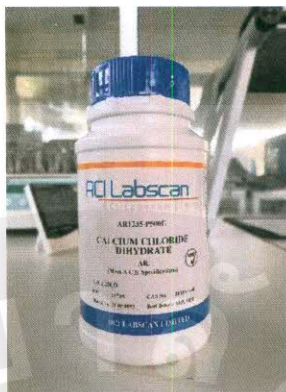
ภาคผนวกที่ 4 \text{CaCl}_2 \cdot 2\text{H}_2\text{O} ใช้สำหรับผสมกับน้ำกลั่น เพื่อเขย่าตัวอย่างในการวิเคราะห์ pH และ EC
