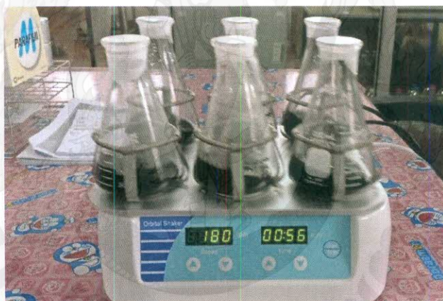
ภาคผนวกที่ 2 เครื่องเขย่า สำหรับเขย่าตัวอย่าง เพื่อวัดค่าความเป็นกรด-ด่าง (pH) และค่าการนำไฟฟ้า (Electrical Conductivity: EC)
