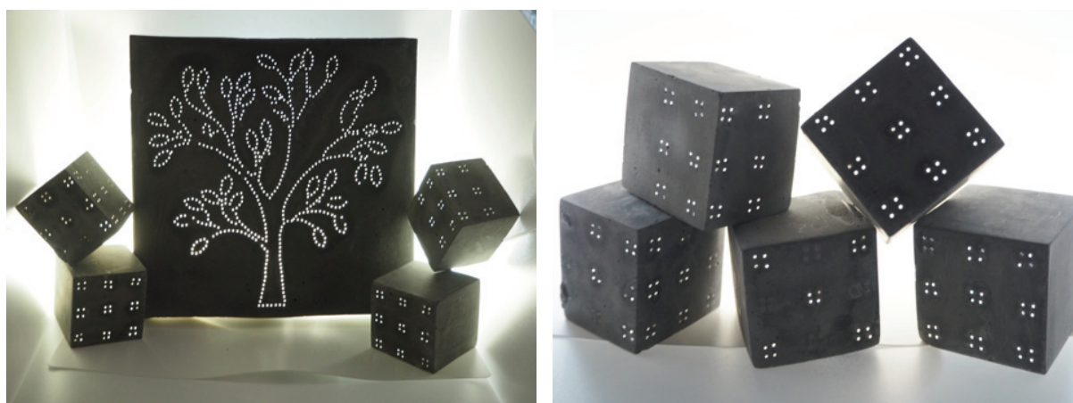
ภาพที่ 1 บล็อกซีเมนต์นำแสงผลิตจากวัสดุเหลือใช้ทางการเกษตร
