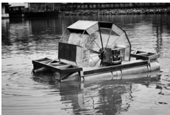
ภาพที่ 2 กังหันน้ำชัยพัฒนา หรือ เครื่องกลเติมอากาศที่ผิวน้ำหมุนช้าแบบทุ่นลอย มีคุณสมบัติในการถ่ายเทออกซิเจน ได้สูงถึง 1.2 กิโลกรัมของออกซิเจน/แรงแม่/ชั่วโมง / ที่มา มูลนิธิชัยพัฒนา, www.chaipat.or.th
