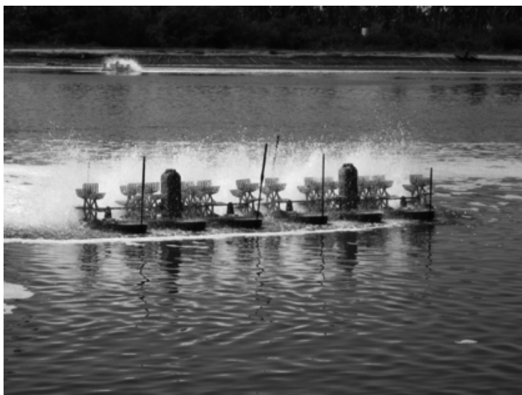
ภาพที่ 3 เครื่องกลเติมอากาศแบบใบพัดตีน้ำ (Paddle wheels)
