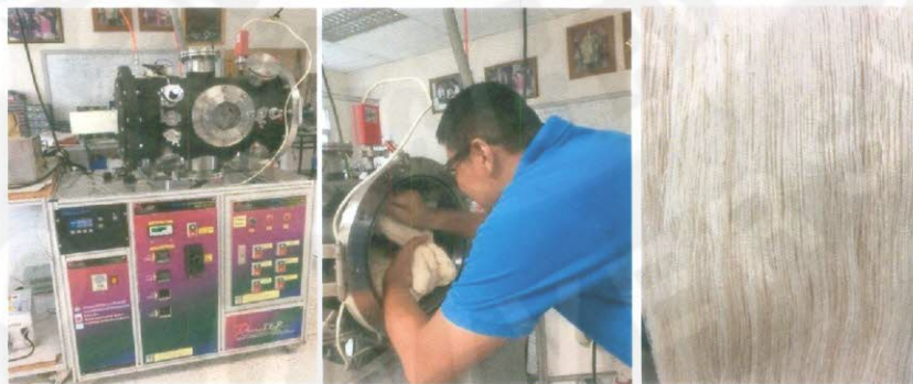
ภาพที่ 16 แสดงการปรับปรุงผิวเส้นด้ายเซมพ์โดยการใช้พลาสติกออกซิเจน
