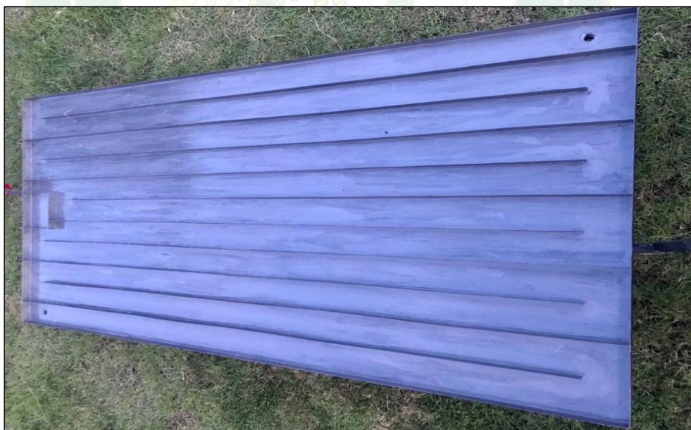
ภาพที่ 51 แผ่นกัน (Buffer) เพื่อควบคุมทิศทางการไหลของน้ำ
