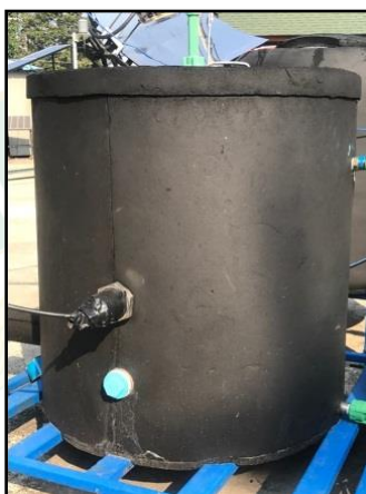
ภาพที่ 29 ถังเก็บน้ำร้อน
