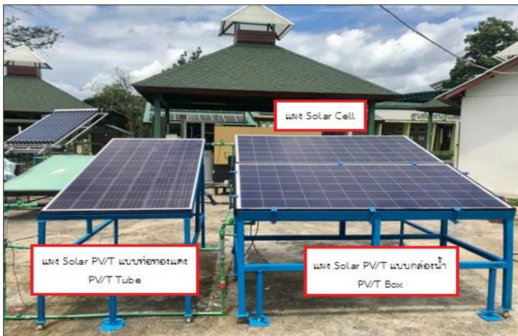
ภาพที่ 28 โมดูลเซลล์แสงอาทิตย์ชนิด Poly Crystalline
