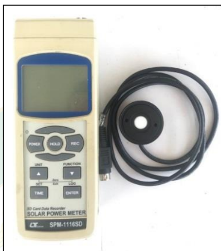
ภาพที่ 43 เครื่องมือตรวจวัดค่ารังสีอาทิตย์
