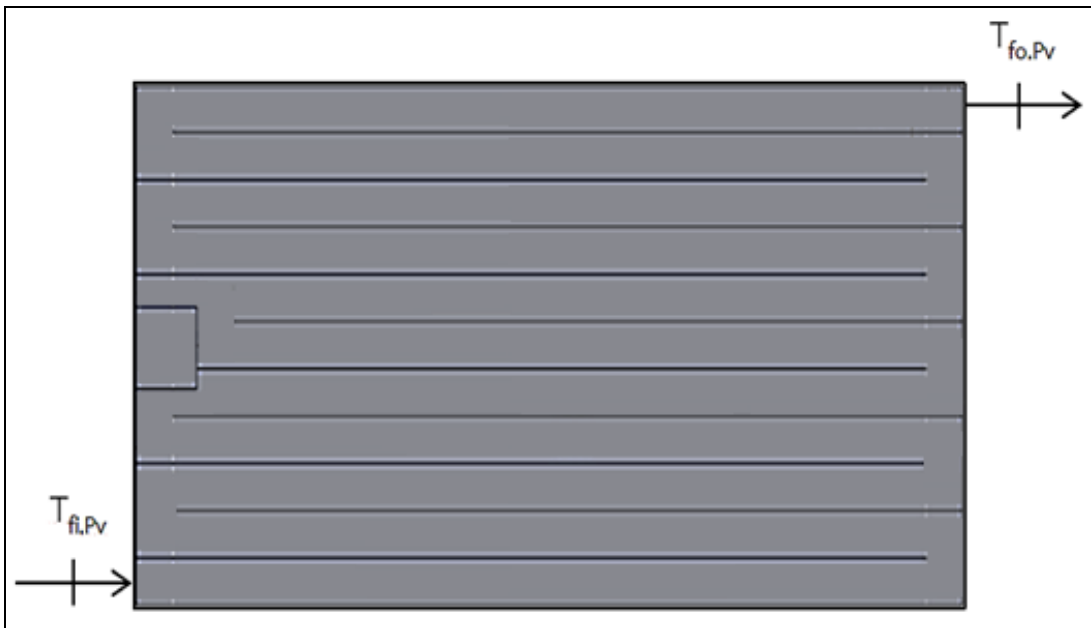
ภาพที่ 31 ทิศทางการไหลของน้ำในกล่องระบายความร้อน
