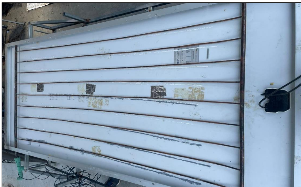
ภาพที่ 50 ท่อทองแดงที่ติดตั้งบริเวณด้านหลังของแผง Solar Cell โดยใช้น้ำไหลในท่อ
