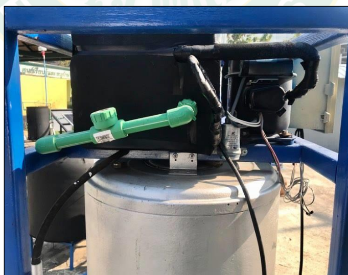
ภาพที่ 48 กล่องน้ำที่ติดตั้งในส่วนระเหยของปั๊มความร้อน
