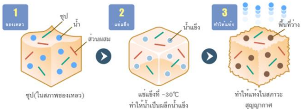
ภาพที่ 8 กระบวนการฟรีซดราย (Freeze-Dried)
