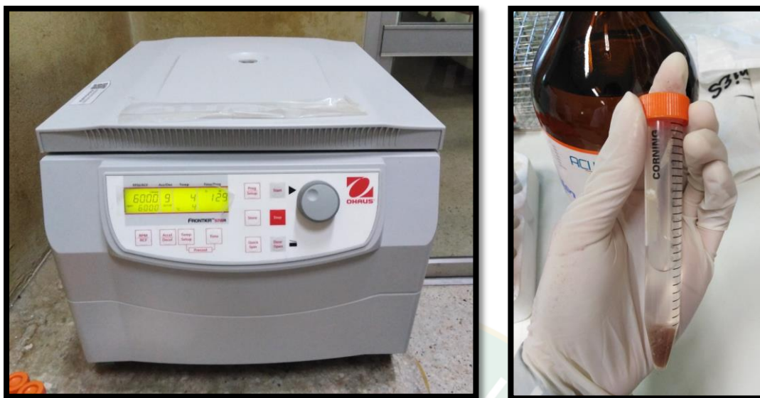
ภาพผนวกที่ 15 ปั่นแยกส่วนผสมระหว่างซากพ่อแม่เพรียงทราย และไดเอททิล อีเธอร์ ที่ความเร็ว 6,000 รอบต่อนาที เป็นเวลา 90 นาที
